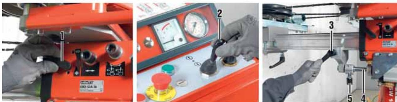
1. Arrêter le mécanisme d'entraînement et appuyer sur le bouton d'arrêt d'urgence sitôt que le fin de course du vérin de serrage est atteint. Bloquer ensuite l'avance au niveau de l'étrier de guidage 1.
