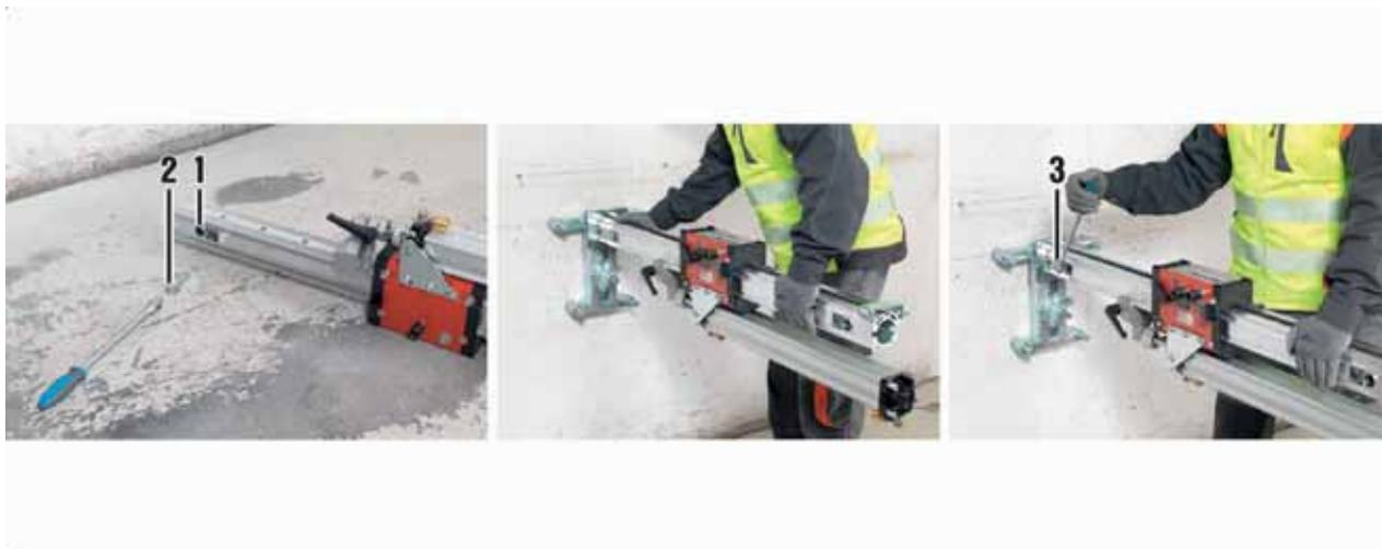
1. Enficher le cône de positionnement dans la glissière de guidage (1) et introduire entièrement le boulon d'excentrique (2).
