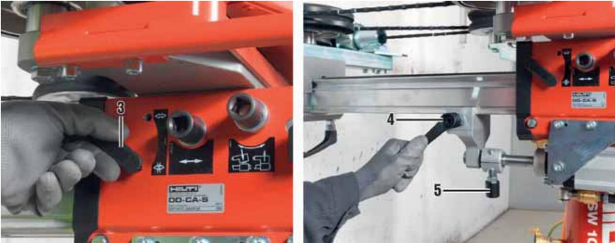
5. Desserrer le dispositif antiretour (4), pousser la tige de piston cylindrique pour la faire complètement rentrer, et serrer la tige de piston et le dispositif antiretour (5).
