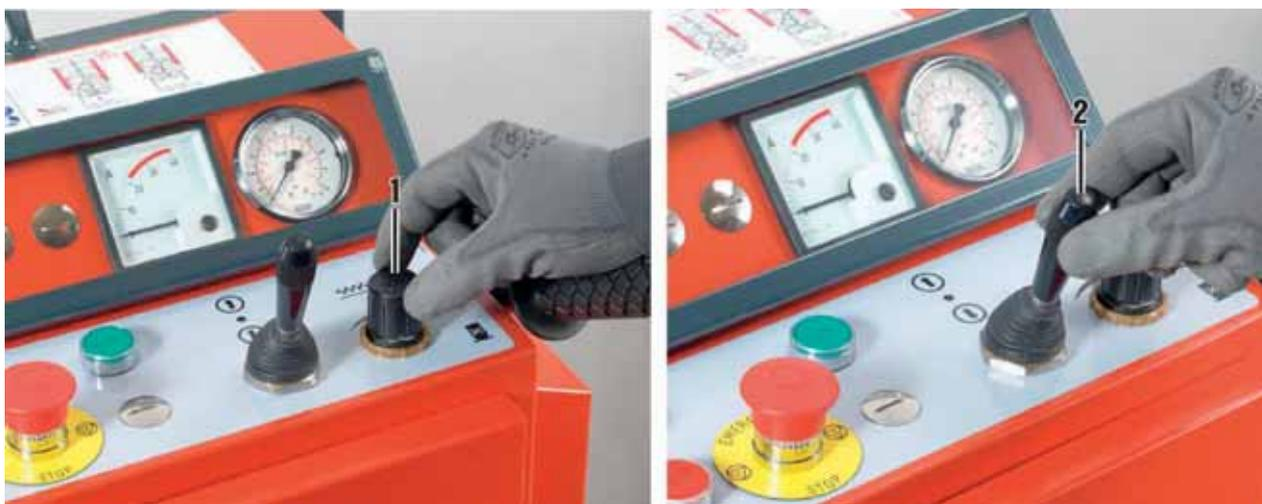
1. Régler la pression d'avance à la valeur recommandée à partir du boîtier de commande et tendre le câble en actionnant la commande d'avance et vérifier que le câble peut être facilement tiré à la main à travers l'entaille.
