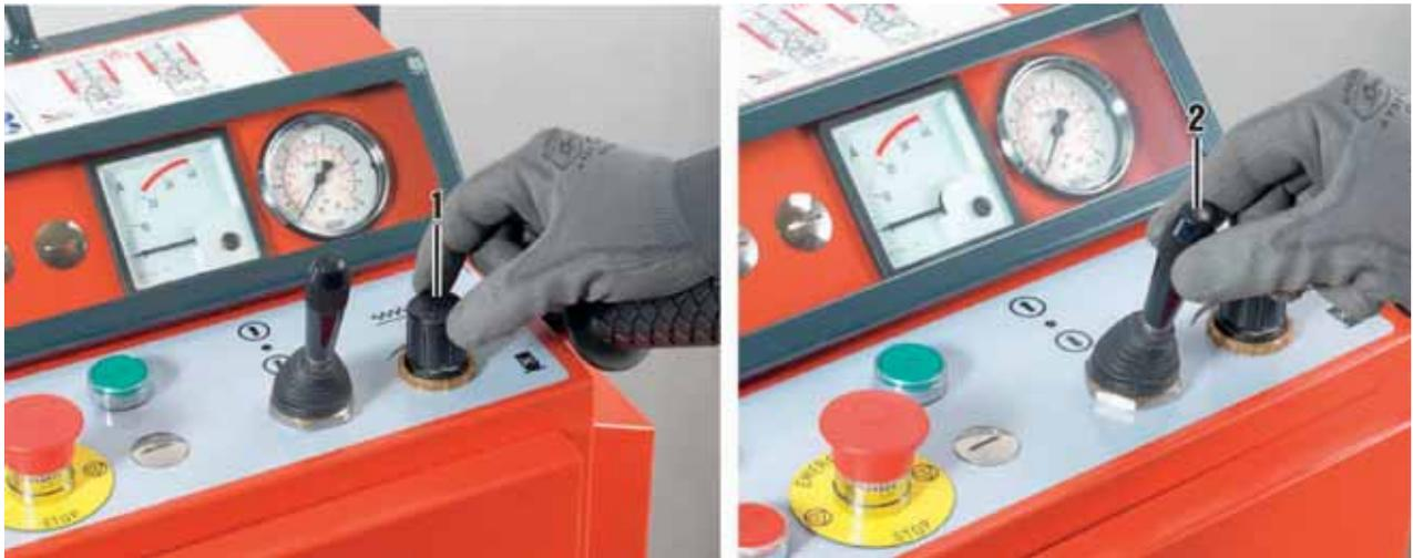
1. Ajuste la presión de avance al valor recomendado en el armario de mando y tense el hilo activando la válvula de avance. A continuación, compruebe si el hilo de sierra pasa fácilmente por la sección de corte con la mano.
