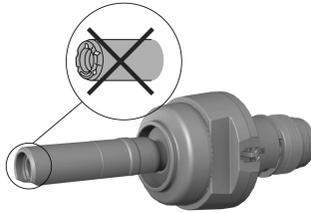
1. Compruebe el desgaste que presenta el guía clavos y sustitúyalo cuando el segmento del guía clavos esté dañado (p. ej. roto, retorcido, abocardado, con fisuras, etc.).
