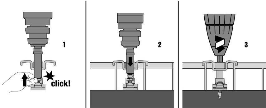
1. Coloque el elemento en el guía clavos.
