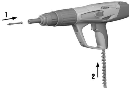
1. Introduzca el elemento de fijación en la herramienta desde delante hasta que la arandela del elemento de fijación quede sujeta en la herramienta.
