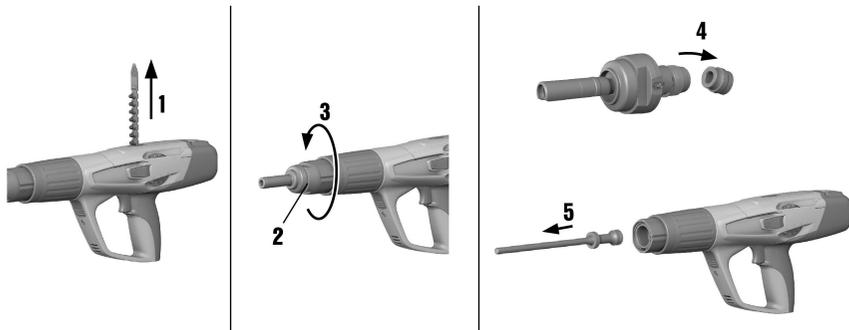
1. Asegúrese de que no haya ninguna tira de cartuchos o un elemento de fijación en la herramienta. Si todavía quedara alguna tira de cartuchos o elemento de fijación en la herramienta, tire de ella con la mano por arriba para sacarla y retire el elemento de fijación del guía clavos.
