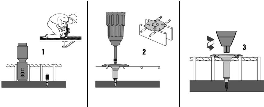
1. Introduzca el perno roscado en el soporte de acero. Utilice el casquillo de contraje para garantizar una fijación centrada. Mida el extremo sobresaliente del perno (NVS) comprobando la profundidad de penetración con el calibre.
