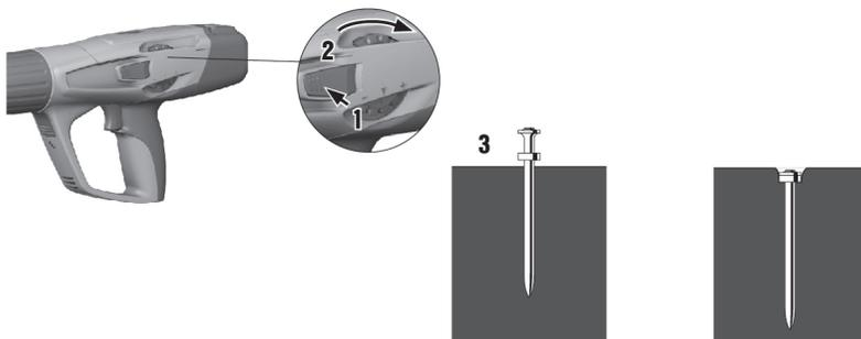
1. Pulse el desbloqueo de la regulación de potencia.
