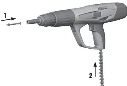
1. Вставьте крепежный элемент спереди до упора в инструмент так, чтобы головка элемента удерживалась в инструменте.
