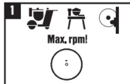
La velocidad (rpm) indicada en el accesorio deberá ser superior a la velocidad de giro de la herramienta. En caso de duda se tendrá en cuenta que la velocidad periférica máxima del accesorio es 80 m/s.
