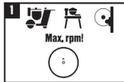
La vitesse (RPM) spécifiée sur l'accessoire doit être supérieure à la vitesse de rotation de l'outil. En cas de doute, la vitesse périphérique d'un accessoire ne doit pas dépasser 80 m/s.
