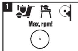
A velocidade (RPM) indicada no acessório deve ser maior que a velocidade da ferramenta. Se houver dúvida, a velocidade periférica máxima de um acessório é 80 m/s.
