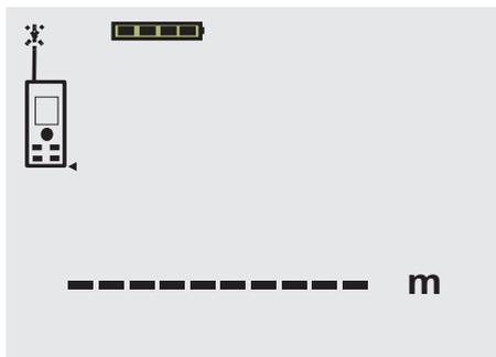
Завизируйте цель. Для измерения расстояния еще раз нажмите клавишу для измерения. Как правило, менее чем через секунду результат будет отображен в строке результата, а лазерный измерительный луч выключен.
