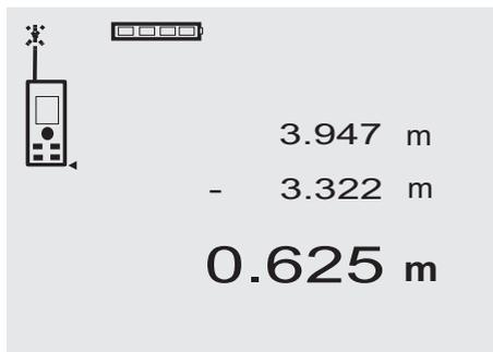
С помощью дальномера удобно производить вычитание расстояний, чтобы, например, определить расстояние от нижнего края трубы до потолка. Для этого нужно вычесть расстояние от пола до нижнего края трубы из расстояния от пола до потолка. Если при этом вычесть диаметр трубы, то можно определить расстояние от верхнего края трубы до потолка.
