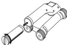
Pousser le bloc-accu à fond dans l'ouverture. Tourner le couvercle d'extrémité dans le sens des aiguilles d'une montre jusqu'à ce qu'il s'enclenche.
