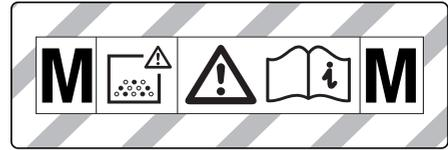
**WARNUNG:** Dieses Gerät enthält gesundheitsgefährliche Stäube. Entleerung und Wartung, einschliesslich der Entfernung des Staubbeutel, dürfen nur von sachkundigen Personen vorgenommen werden, die geeignete persönliche Schutzausrüstung tragen. Nicht einschalten, bevor das komplette Filtersystem installiert ist und die Funktion der Volumenstromkontrolle überprüft wurde.
