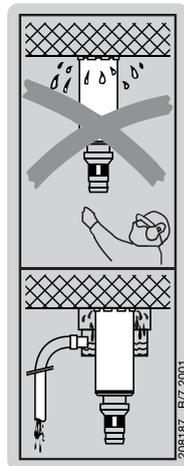
Pour des travaux au plafond, le système de récupération d'eau doit impérativement être utilisé avec une aspiration.
