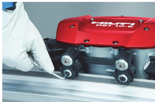
1. Poser le rail au sol et fixer la scie sur le rail.
