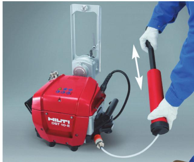
1. Connecter l'embout de purge sur le flexible de la pompe.
