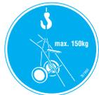
Les chariots de transport de la tête de scie et d'accessoires peuvent être levés à l'aide d'une grue ou d'un élévateur uniquement à partir des points autorisés à cet effet.
