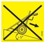
Le chariot de transport peut devenir instable et se renverser si utilisé sur des surfaces inclinées ou non planes.
