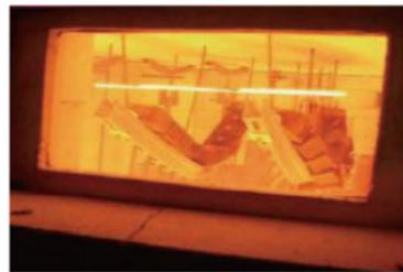
MQ安装吊挂系统的耐火试验
