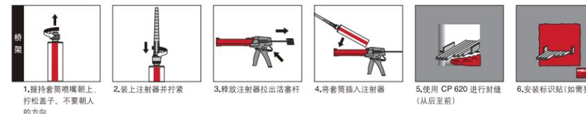
1. 握持套筒喷嘴朝上，拧松盖子，不要朝人的方向 2. 装上注射器并拧紧 3. 释放注射器拉出活塞杆 4. 将套筒插入注射器 5. 使用 CP 620 进行封缝(从后至前) 6. 安装标识贴(如果需要)
