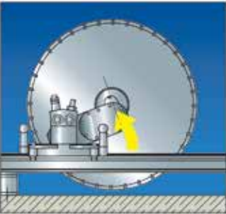
靠液压移动锯臂到固定锯片的孔位置
