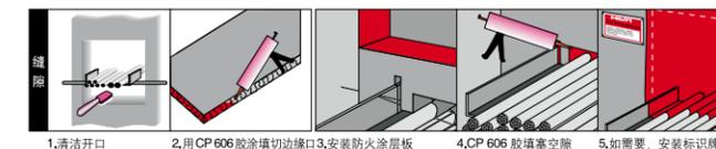
1.清洁开口 2.用CP 606 胶涂填切边缘口 3.安装防火涂层板 4.CP 606 胶填塞空隙 5.如需要, 安装标识牌
